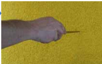
Per facilitare l'inserimento delle viti usare un punteruolo
